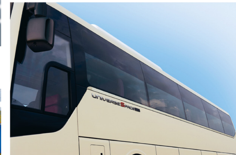
Водительское окно имеет двойное остекление для обеспечения хорошей шумоизоляции
