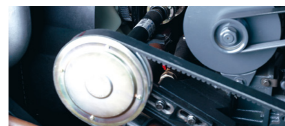
Электромагнитная муфта привода вентилятора (обеспечивает низкий уровень шума)
